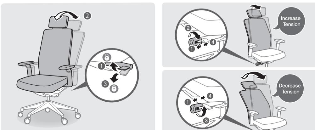
Сяд на кресле, потяните наружу шток регулировки справа под сиденьем (1). Покрутите шток по часовой или против часовой стрелки для регулировки усилия натяжения механизма наклона (2, 3). Зафиксируйте настройки, вернув шток в исходное положение (4).
