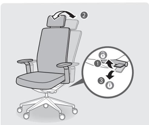
Сяд на кресле, потяните на себя рычаг регулировки слева под сиденьем (1). Установите нужный угол наклона спинки, откинувшись на нее (2). Зафиксируйте положение, повернув рычаг от себя (3) до характерного щелчка.
